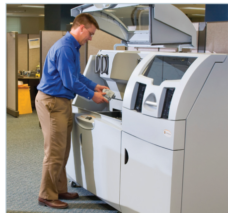
Ilustración 2. La impresora de Z Corporation ZPrinter 650 produce piezas a una velocidad de 1.1 pulgada vertical (28 mm) por hora con una longitud y una anchura de 10 x 15 pulgadas (254 x 381 mm).
