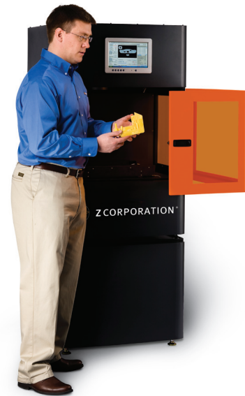
Ilustración 10. La ZBuilder Ultra de Z Corporation produce piezas con un acabado de superficie liso, detalles definidos y propiedades mecánicas similares al plástico ABS.
