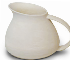
Ilustración 3. Diseño de una jarra de Denby Pottery que parte de un esbozo, para convertirse en un modelo CAD 3D y luego en un prototipo físico impreso realizado con una ZPrinter de Z Corporation.
