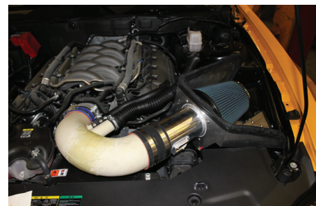
Ilustración 9. Ejemplo de prototipo operativo de una entrada de aire (componente de color blanco) de Steeda Autosports fabricado con una ZPrinter para la fase de pruebas.
