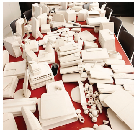
Ilustración 4. Utilizando una rápida y económica ZPrinter, Cisco a menudo produce prototipos para evaluar conceptos de diseño.
